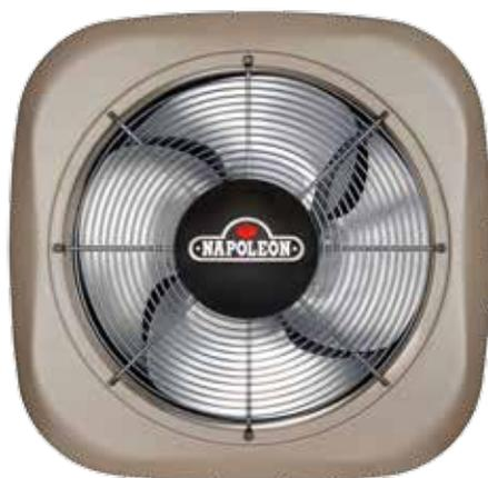
Les climatiseurs de 1,5 et de 2 tonnes de Napoléon sont dotés d'un ventilateur à quatre pales conçu pour répondre aux besoins de refroidissement de l'unité. Les climatiseurs de 2,5 à 5 tonnes sont dotés d'un plus gros ventilateur à deux pales qui fournit une plus grande quantité d'air, nécessaire pour les grandes unités.
